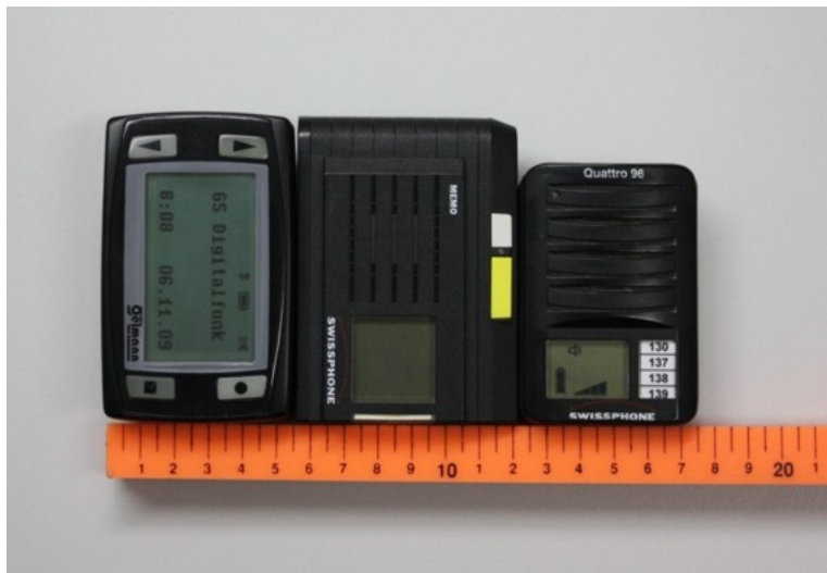
Groote vergelijking van de Oelmann Tetra signaalgever Viper (links) met analoge signaalontvangers van Swissphone
