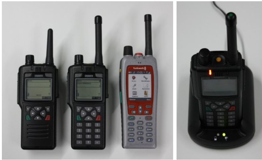
Links een STP8000 van Sepura met een gereduceerd toetsenbord (prototype FHRT), in het midden de standaard versie STP8000, rechts een FT4 PS van Funkwerk . Op de rechter foto de STP8000 in het laadstation; de oranje noodknop aan de bovenkant is hier duidelijk zichtbaar.
