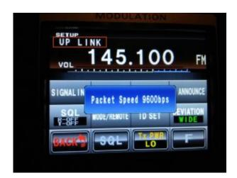
Jetzt tippen wir oben links auf "UP LINK" bis im Display "Packet Speed 9600bps" steht (wie auf dem Bild zu sehen).
